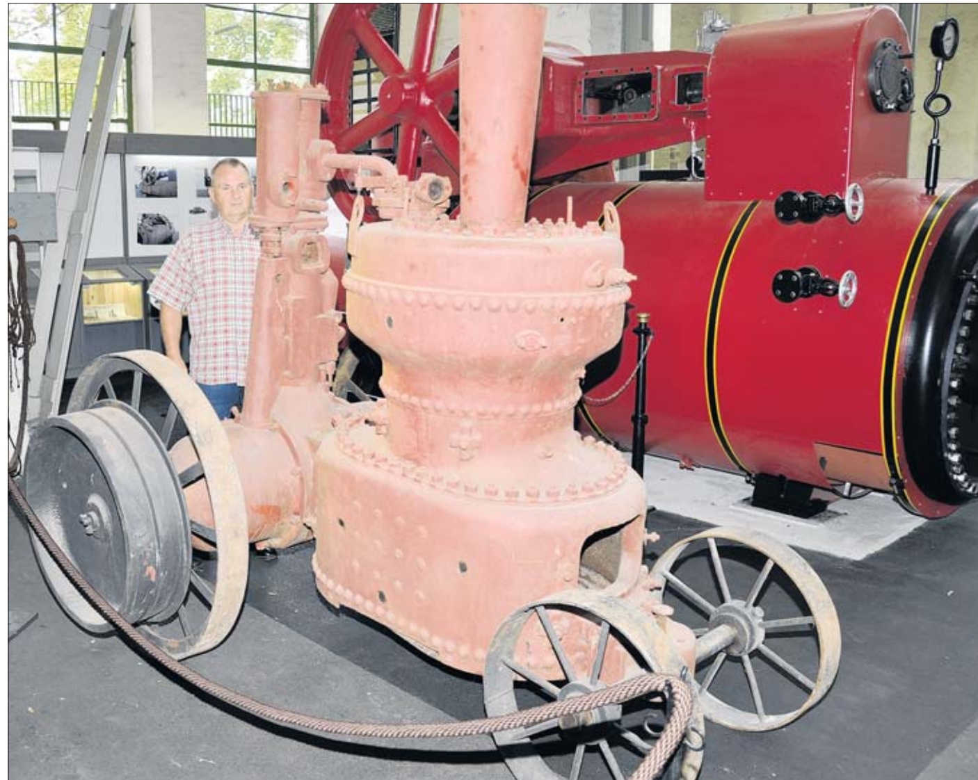
Technikmuseumschef Gerhard Unger an der Patent-Heißdampf-Motor-Lokomobile, vorn mit dem Dampfkessel, dahinter dem Kolbengehäuse und links am Rad mit dem Antriebsrad. Foto: Rainer Schweingel
