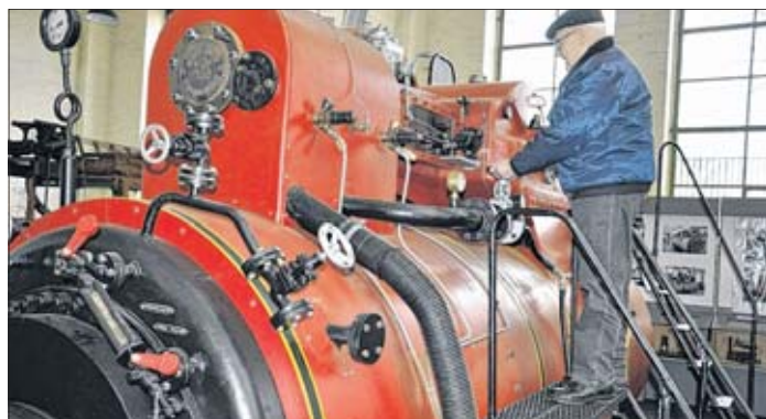
Günter Birkholz beim Bedienen der Wolfschen Einzylinder-Heißdampf-Lokomobile EH 9, die einst im SKL gefertigt und im Technikmuseum saniert wurde.
