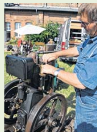
Konrad Jessen demonstriert den Kaelble-Ein-Zylinder-Glühkopfmotor von 1925.
