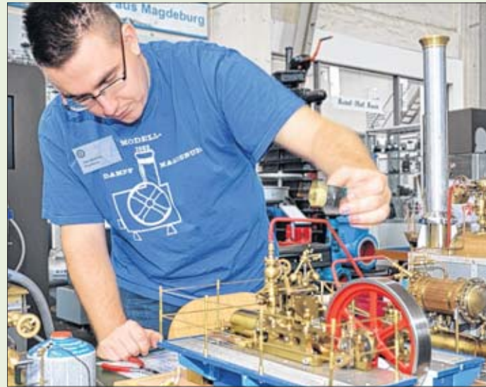
Tino Birkholz ist 23 Jahre alt. Er füllt das Öl in einer einzylindrigen schiebgesteuerten Dampfmaschine nach.
